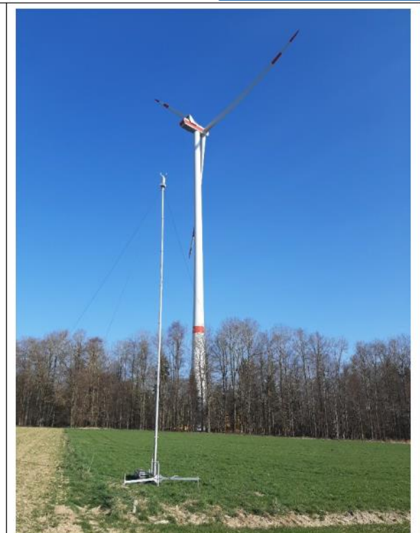
Windmessmast mit Blick in Richtung WEA
