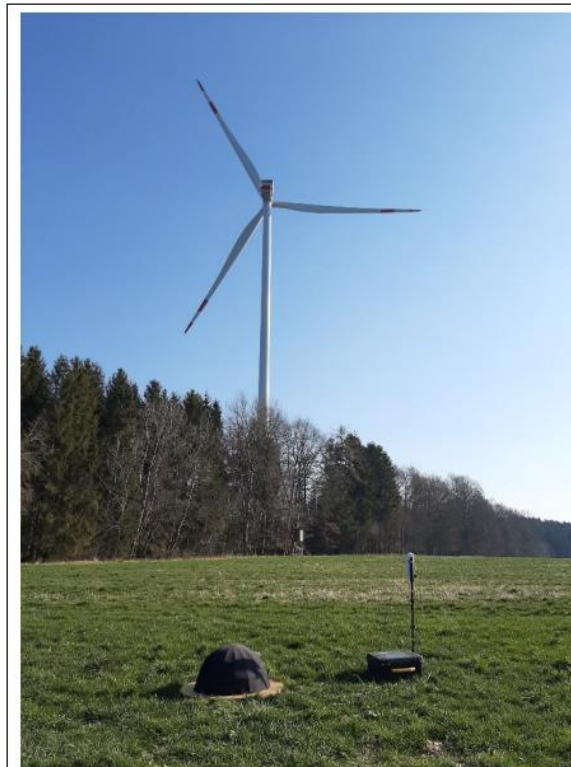
Mikrofon auf schallharter Platte am Messpunkt MP1 mit Blick in Richtung WEA
